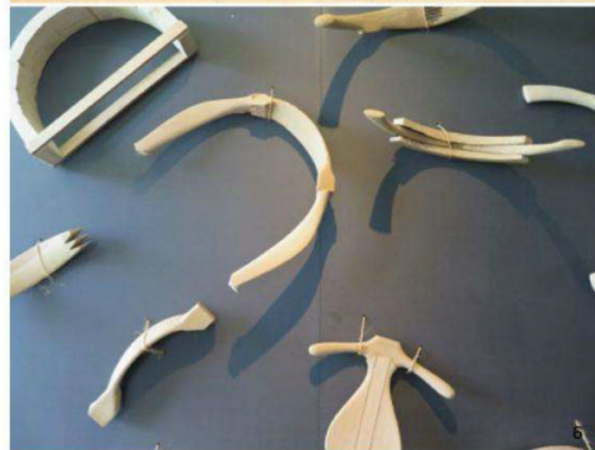
5. Y Chair 的設計草圖。©Designmuseum Danmark 6. 椅子的分解零組件，可看出細木工藝的精湛之處。©Kunstmuseet i Tønder 7. Wegner 手折模型。他習慣在劃出草圖後，藉著製作模型，將構想具體化。
