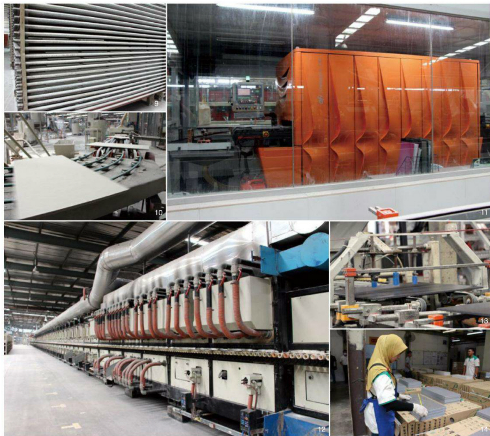
8. 歐洲進口的磁磚印刷機器。9. 粗胚整齊的在架上風乾。10. 輸送帶上的粗胚像是河上的行船。11. 義大利的最新磁磚噴墨繪圖機。12. 長到似乎不見盡頭的電子窯。13. 鑒鑒作響的硬度測試起。14. 抽驗把關的最後一步還是交給人來處理。
