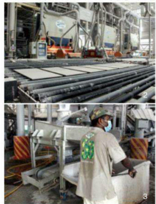
1. 「人」在現代工業中仍扮演重要角色。2. 剛壓製好的粗胚。3. 工作人員與汗濕的衣衫。4. 磁磚的原形——磁土。5. 高速運轉的滾筒日夜不停混合材料。6. MML 採光、通風良好的廠房。7. 高大壯觀的貯存槽。
